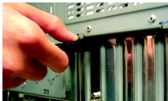
B-1. 將 GIGABYTE 影像轉接頭連接至顯示卡的 TV Out 插頭
