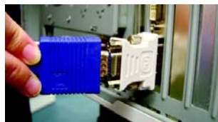
使用 DVI-I 轉 D-Sub 轉接器連接 D-Sub 螢幕
