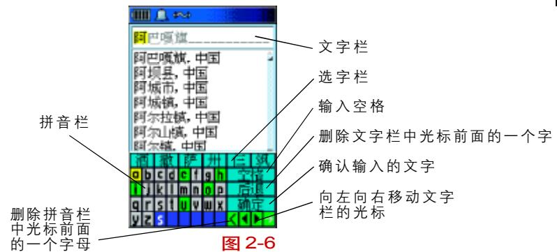
● 再次使用方向键选择字母“h”，按下输入键确认，再依次以同样的方法选择字母“a,n,g”，如图2-7所示，光标已经停留在“上”字上，如果需要在选字栏选择字，可以向左/向右移动方向键，按下缩小键可以查看选字栏的下一页；
