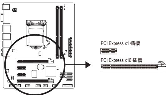
请依下列步骤将适配卡正确地安装于主板的适配卡插槽内：
