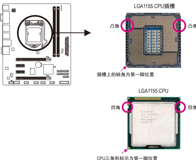
B. 请依下列步骤将CPU正确地安装于主板的CPU插槽内。
