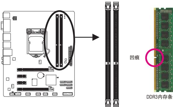
DDR3内存条上有一个凹痕, 只能以一个方向安装至内存条插槽内。请依下列步骤将内存条正确地安装于主板的内存插槽内。
