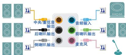
以四声道为例，若您将后喇叭输出设备连接至中央/重低音输出的孔位，仅需经由音频软件将中央/重低音输出孔位重新定义成后喇叭输出功能，即可正常使用。
