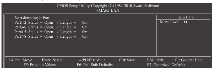
本主板具备网线检测功能, 帮助用户可以在BIOS中确认目前网络连接情况是否正常, 若线路故障时也可报告故障位置。请参考以下说明:
