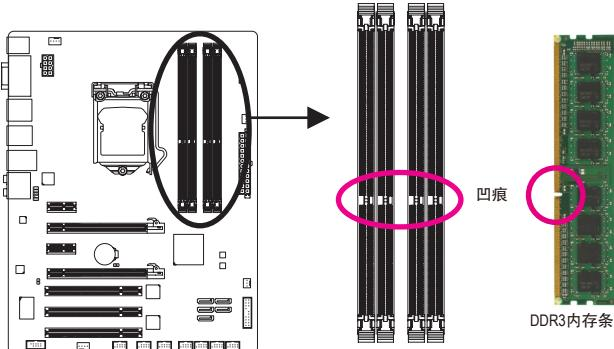
DDR3内存条上有一个凹痕，只能以一个方向安装至内存条插槽内。请依下列步骤将内存条正确地安装于主板的内存插槽内。
