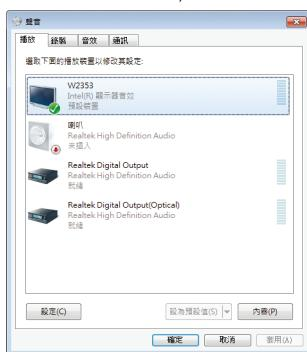
在Windows 7进入此选单，请在开始>控制面板>硬件和音频>声音>播放，将「Intel(R)显示器音频预设」设为预设值。
