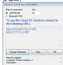
在通知区域中找到Cloud OC图标，在图标按右键选择「Start Server」即可开启「Cloud OC Server」。「Cloud OC Server」会提供Cloud OC服务器位址，在任何已连接至网络的设备的浏览器中输入此网址，即可进入Cloud OC服务器。
