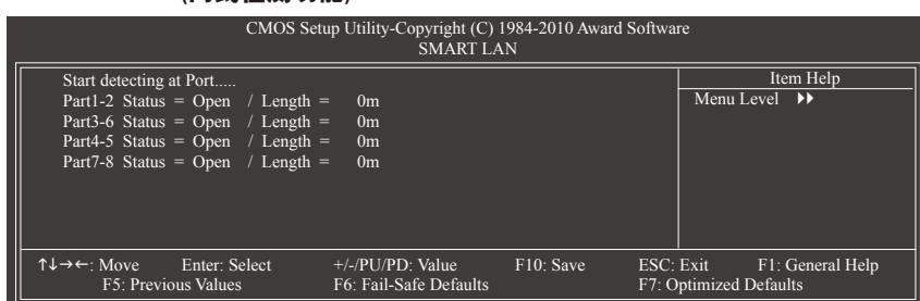
本主板具备网线检测功能, 帮助用户可以在BIOS中确认目前网络连接情况是否正常, 若线路故障时也可报告故障位置。请参考以下说明:
