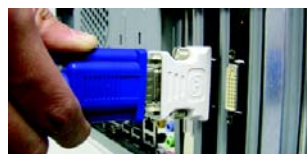
使用 DVI-I 轉 D-Sub 轉接器連接 D-Sub 螢幕
