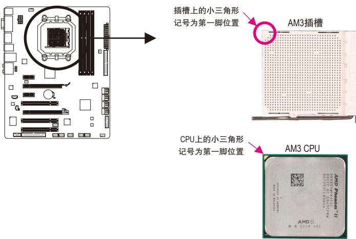
B. 请依下列步骤将CPU正确地安装于主板的CPU插槽内。
