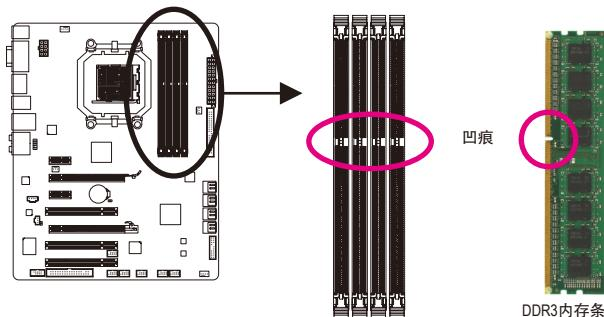
DDR3内存条上有一个凹痕，只能以一个方向安装至内存条插槽内。请依下列步骤将内存条正确地安装于主板的内存插槽内。
