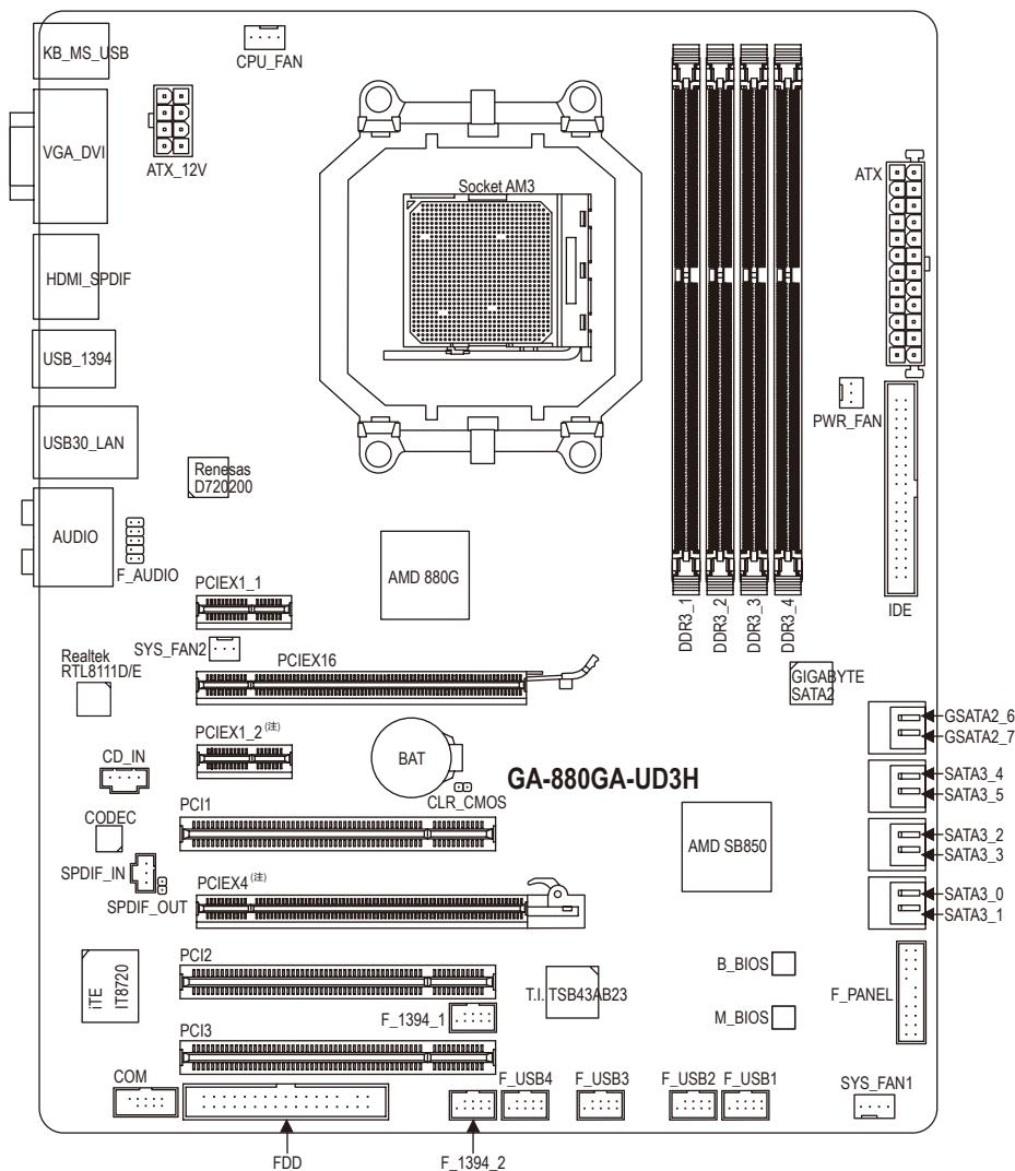
(注) 由于PCIEX1\_2插槽与PCIEX4插槽共享频宽，所以当PCIEX4插槽安装了PCIe x4规格以上的适配卡时，PCIEX1\_2插槽将无法使用。
