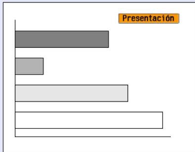
Cada vez que cambia el modo de color, el ajuste actual aparece en la esquina superior derecha de la pantalla. Mientras el nombre del modo de color aparece en la pantalla, la única forma de cambiar al modo de color siguiente es presionando el botón.
