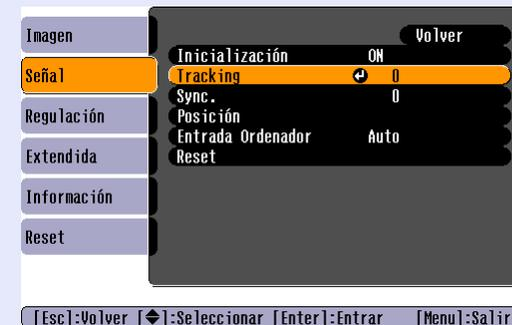
**2 Ajuste el tracking hasta que las bandas verticales desaparezcan de la imagen.**
