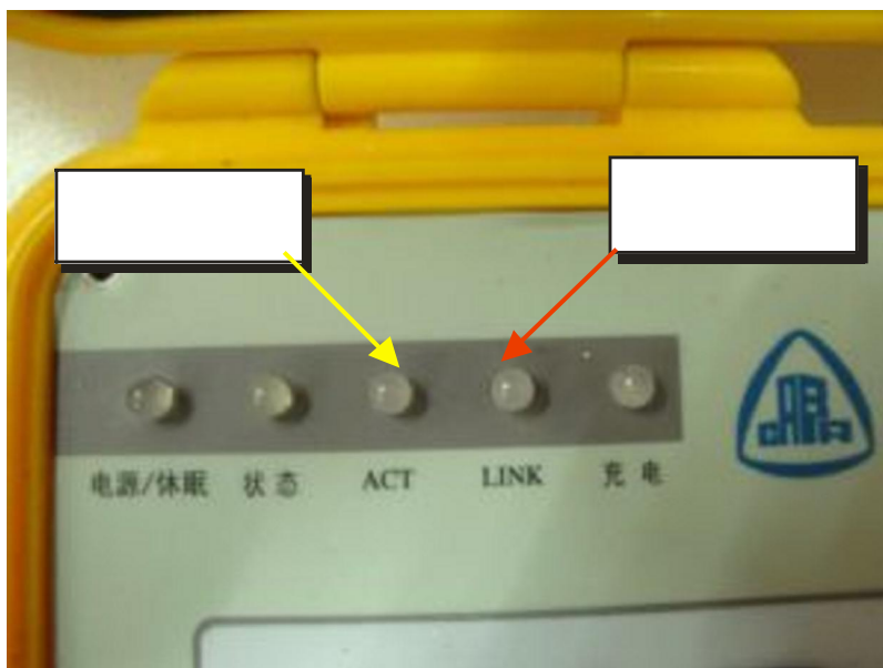
图 1.3 以太网连接指示
