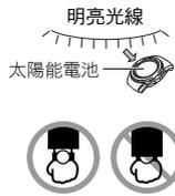
本錶內置的充電電池會儲存由太陽能電池產生的電能。在照射不到光線的地方放置或使用本錶會使電池的電量耗盡。請盡量讓手錶照射到光線。
