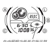
本表采用一块 LCD(电子荧光)板作为照明，其可点亮整幅显示屏幕，即使在黑暗中亦可使画面明亮易观。本表还配自动照明功能，只要将手面向您转动，照明便会自动点亮。
