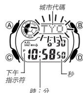
1. 在計時功能畫面顯示時，按住 (A) 鈕直到城市代碼開始閃動。此表示現已進入設定畫面。
