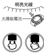
本錶內置的充電電池會儲存由太陽能電池產生的電能。在照射不到光線的地方放置或使用本錶會使電池的電量耗盡。請儘可能讓手錶照射到光線。
