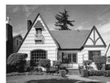
Quando um bocal da cabeça de impressão estiver bloqueado, a amostra impressa assemelha-se a isto.
