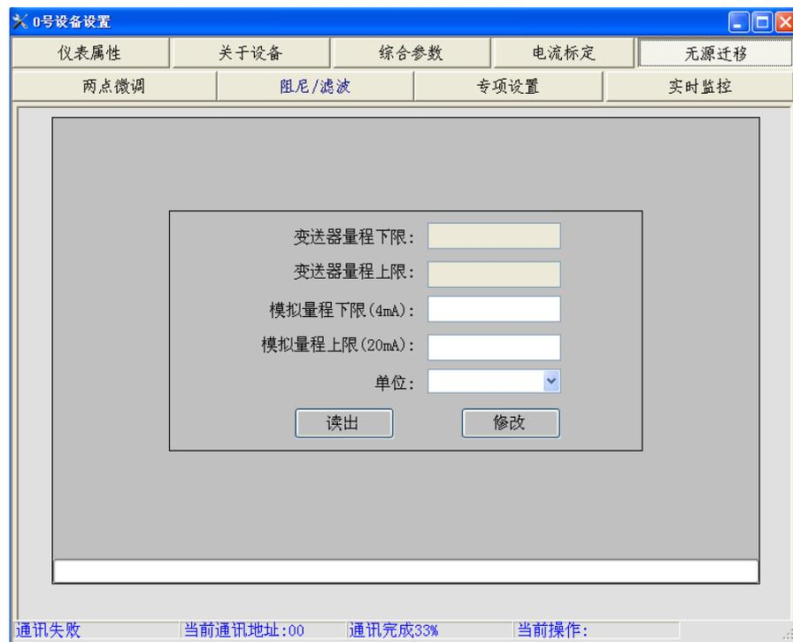
模拟量程下限: 4mA 对应的压力值
