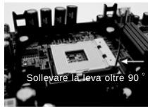
PROCEDURA 1: Sollevare la leva della presa di oltre 90° gradi
