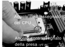
PROCEDURA 2/PROCEDURA 3: Inserire l'angolo contrassegnato del CPU nell'angolo contrassegnato nella presa
