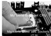
SCHRITT 2/ SCHRITT 3: Die markierte Ecke der CPU zu der markierten Ecke des Sockels anpassen.
