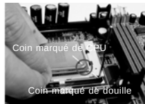
ÉTAPE 2/ ÉTAPE 3 : Assortissez Le Coin Marqué de CPU au Coin Marqué de Douille
