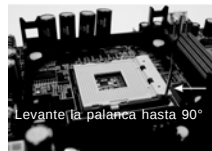
PASO 1: Levante la palanca del zócalo hasta 90°
