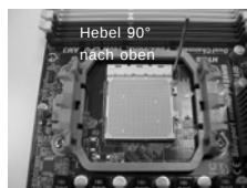
SCHRITT 1: Ziehen Sie den Sockelhebel hoch
