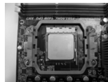
步骤 4： 下推并锁住插座拉杆
