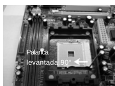
PASO 1: Levante la Palanca del Zócalo
