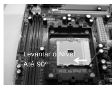
PASSO 1: Levantar o Nível de Tomada Até 90°
