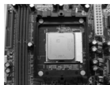
FASE 4: Abbassare e bloccare la levetta socket
