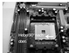
SCHRITT 1: Ziehen Sie den Sockelhebel hoch
