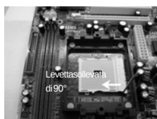
FASE 1: Sollevare la levetta socket
