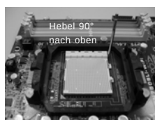
SCHRITT 1: Ziehen Sie den Sockelhebel hoch
