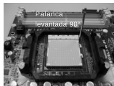
PASO 1: Levante la Palanca del Zócalo
