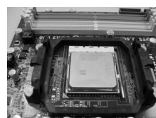
FASE 4: Abbassare e bloccare la levetta socket
