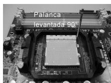
PASO 1: Levante la Palanca del Zócalo
