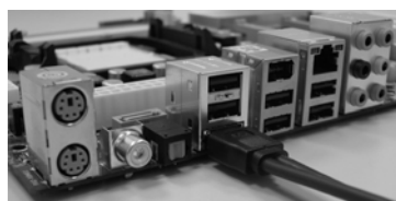
Collegare un'altra estremità del cavo della periferica eSATAII alla porta eSATAII dello schermo I/O
