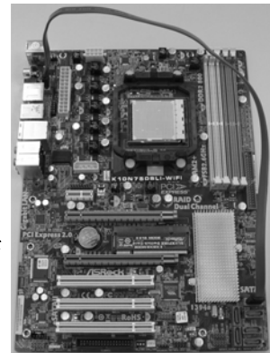
SATAデータケーブルをeSATAIIコネクタ(eSATAII_TOP)に接続します
