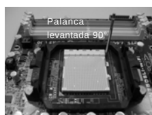
PASO 1: Levante la Palanca del Zócalo
