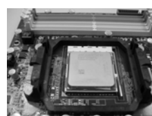
FASE 4: Abbassare e bloccare la levetta socket
