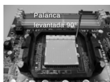
PASO 1: Levante la Palanca del Zócalo
