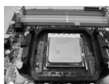
FASE 4: Abbassare e bloccare la levetta socket
