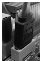
Collegare il cavo dati SATA al connettore eSATAII (eSATAII_TOP)
