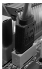
SATAデータケーブルをeSATAIIコネクタ(eSATAII_TOP)に接続します
