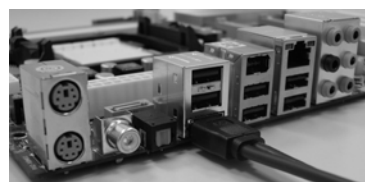
Collegare un'altra estremità del cavo della periferica eSATAII alla porta eSATAII dello schermo I/O
