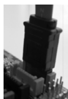
将 SATA 数据线连接到红色的 SATAII 接口 (SATAII_RED(PORT1))
