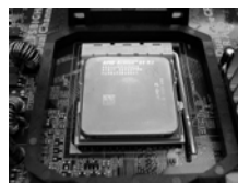
ステップ 4 ソケットレバーを押し下げてロックします
