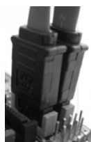
SATA データケーブルを赤い SATAII コネクタ (SATAII_RED (PORT1)) とオレンジの SATAII コネクタ (SATAII_ORANGE (PORT2)) の両方に接続します
