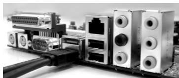
将 eSATAII 设备连线的另一端连接到 I/O 挡板的 eSATAII 设备
