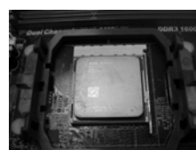
步骤 4： 下推并锁住插座拉杆
