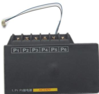
■ 分励模块与带分励型控制器配套使用，实现分励功能。
