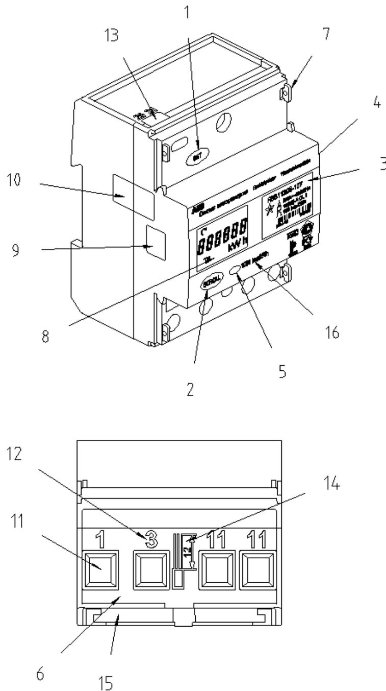
*Fig. 2-1 Meter parts*
