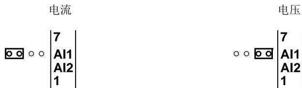
AI2 - 确定模拟输入 AI2 用作电流输入还是电压输入。
