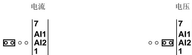
T - 变频器到变频器的连接终端。当变频器为连接中的最后一个单元时，必须设置到 ON 的位置。
