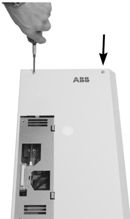
13. 首先将盖板向上滑动，然后将盖板提起脱离。
