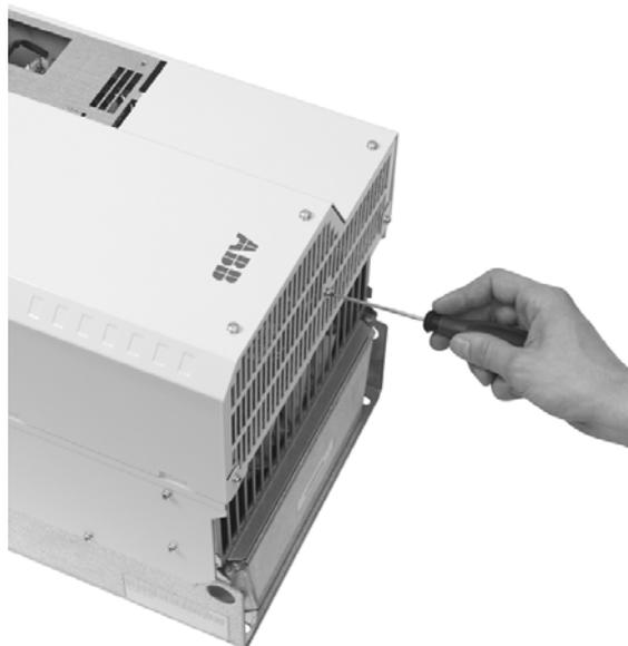
4. 拆掉支撑变频器模块盖板的三个螺钉。
