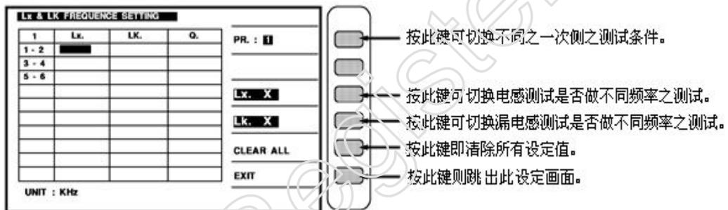
如上图所示为本测试机出厂之预设值，欲更改不同测试频率时只须使用 Cursor 之上下左右四按键移动显示器之反白区到各测试组再输入测试频率即可。
