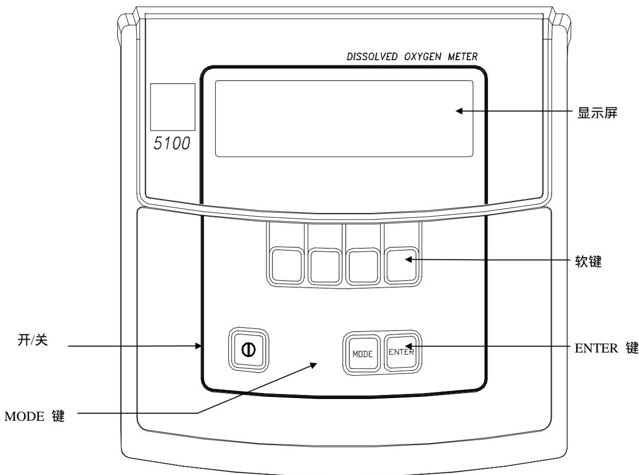
5000/5100 有两种操作模式：主模式和应用模式。当前模式将以暗条显示于显示屏的右上角，下图是仪器在主模式下的显示屏：
