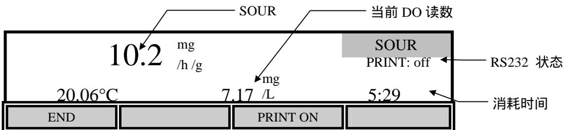
SOUR 值显示于屏幕上并且大约每秒更新一次。在测量 SOUR 时按[PRINT ON]可将读数发送给电脑或串行打印机，格式如下：
