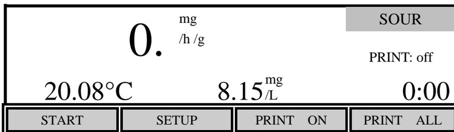
按[SETUP]设置 SOUR 参数，下面屏幕显示省缺参数：
