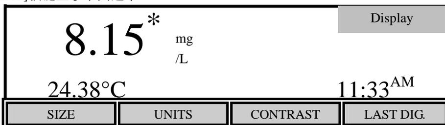
[SIZE]软键是主模式下两种显示方式的循环转化。一种是尽可能多参数，另一种是以大字体显示溶解氧，小字体显示温度和时间。这些不同显示方式只适用于主模式下。在校准模式下会显示所有参数。
