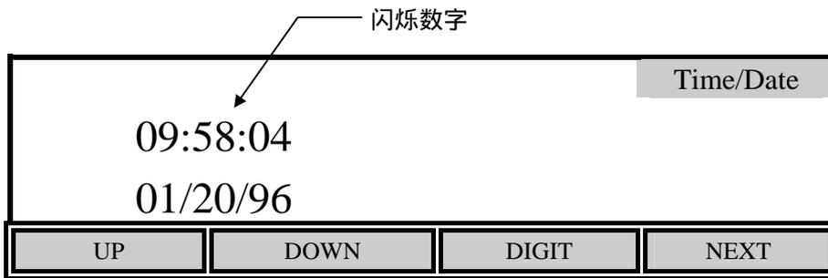
用 UP, DOWN, DIGIT 和 NEXT 软键输入时间（24 小时格式）。按[UP]或[DOWN]增大或减少闪烁的数字，按住软键则数字连续变化直至释放该键，作较在改变时可以使用[DIGIT]键。设置小时后按[NEXT]移动光标至下一个参数一分钟。重复过程完成其它参数的设置。
