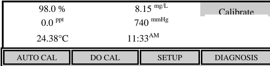
7. 5100 型：确认气压计读数是正确的。若必要请参阅后面 *校准 - 气压计* 章节所述校准气压计。
