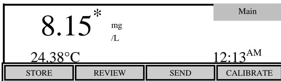
显示屏下端显示在主模式中四个软键的功能，主模式是用于测量、储存可调回读数和发送当前读数给电脑或串行打印机。
