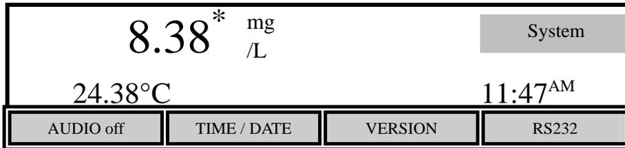
[AUDIO off]软键允许设置“嘟嘟声”的开或关。这个键在[AUDIO off] 和[AUDIO on]之间触发转化，“嘟嘟声”的当前状态与软键所显示的功能相反，如果当前“嘟嘟声”是开，则软键显示“AUDIO off”；反之亦然。
