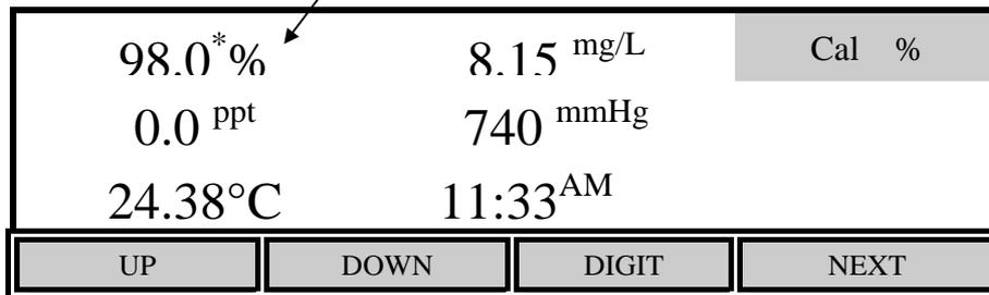
3. 等待显示读数稳定后，用[UP]、[DOWN]和[DIGIT]软键输入百分比饱和度校准值。参阅 *附录 A - 溶解度表* 和 *附录 B - 压力及高度手动校准值*。
