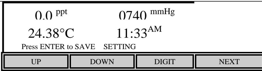
用[UP]、[DOWN]和[DIGIT]软键输入真实的当地气压，这个读数可用水银柱气压计读得，请不要使用气象台根海平面压力得出的报告。
