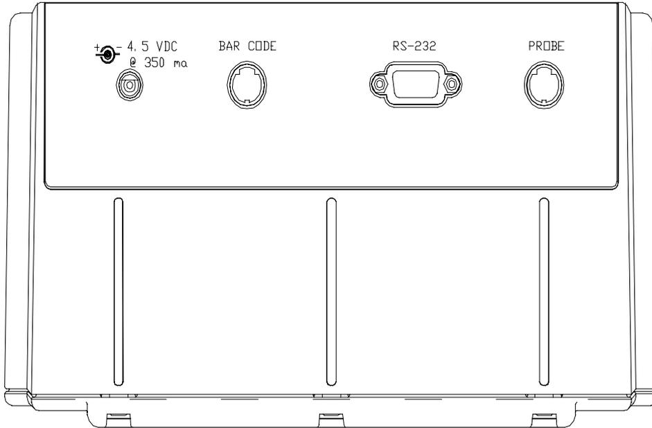
1. 电源插头：电源输入为-4.5 至 5.5VAC，最小电流 350ma。
