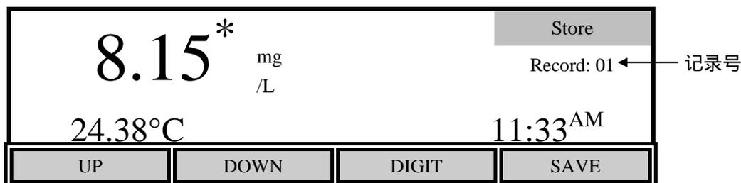
储存选单用于控制数据储存，当前记录号显示于屏幕的右边。按[SAVE]软键储存当前显示的数值，屏幕会出现信息“Record X SAVED”（X 是记录号码），同时记录号增加定位至下一个储存单元。如果你想把记录储存到一个指定的单元，用[UP]、[DOWN]和[DIGIT]软键选择内存记录号。如果指定的记录号已包含数据，你会看到提示警告该内存已包含数据。
