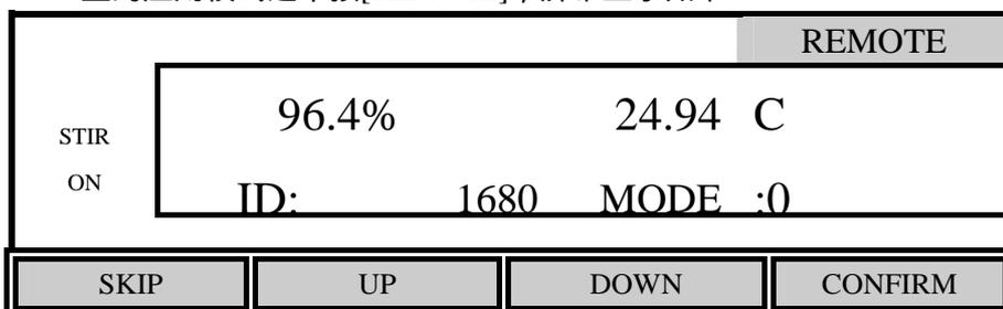
遥控模式是用于与 YSI 5910 BOD 分析软件一起使用以大大减少处理 BOD<sub>5</sub> 和计算 BOD 值的人工操作。遥控模式也用于通过电脑某些标准通讯程序操控 5000/5100 型，详见附录 D - 遥控命令语句。
