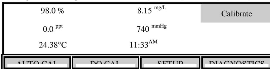
下一步，按[SETUP]软键进入设置选单。显示屏下端显示四个软键设置选项，用于改变仪器设置。
