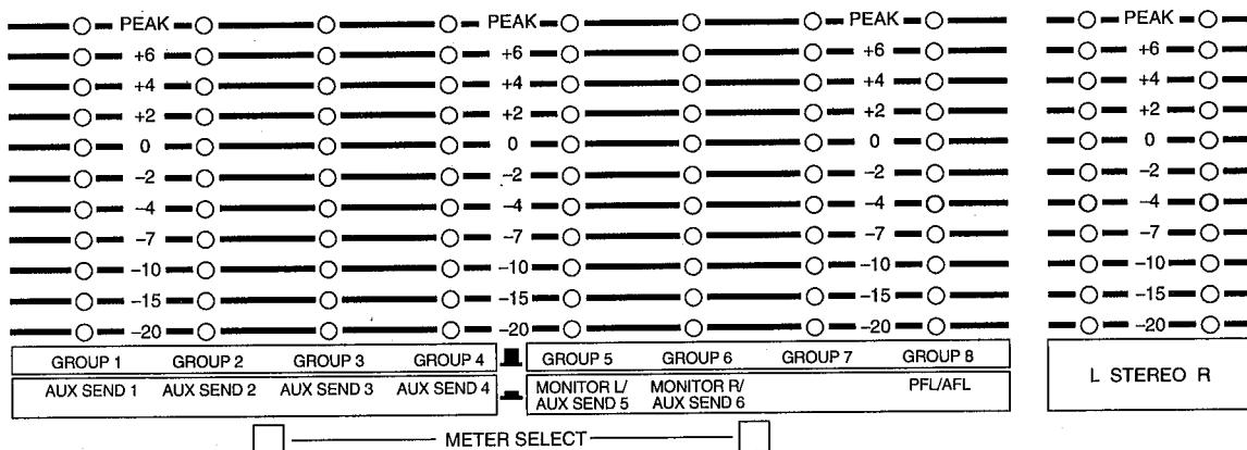
Le RM800 comprend dix indicateurs à diodes à 11 segments, offrant des indications de niveau pour toutes les sorties. Les indicateurs STEREO sont réservés à la sortie stéréo tandis que les indicateurs GROUP constituent des indicateurs à fonctionnement double. Les commutateurs METER SELECT (sélection d'indicateur) vous permettent de choisir le signal à surveiller. Le tableau suivant vous montre la répartition des contrôles.
