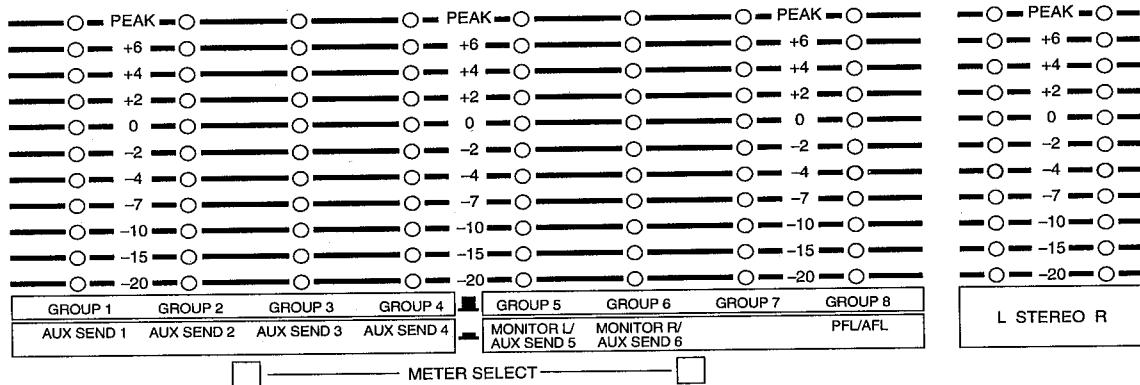
Das RM800 ist mit zehn 11gliedrigen LED Metern ausgestattet, die den Pegel aller Ausgänge anzeigen. Die STEREO Meter sind den Stereo-Ausgängen vorbehalten, während die GROUP Meter zwei verschiedene Pegelwerte anzeigen können. Mit den METER SELECT Tastern können Sie das Signal wählen, das angezeigt werden soll. Weitere Einzelheiten entnehmen Sie bitte folgender Tabelle:
