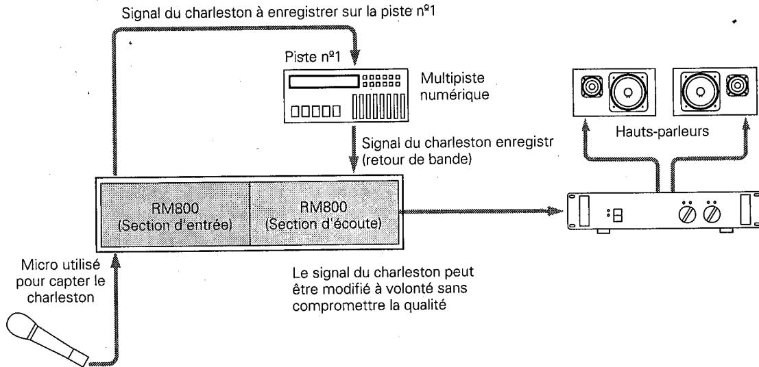
Sur une console in-line, la *reproduction* du multipiste peut être mixée comme il convient au moyen de la section d'écoute d'un module de canal tandis que le curseur d'entrée, l'EQ, etc. servent à optimaliser le niveau de signal sur chaque piste de l'enregistreur.
