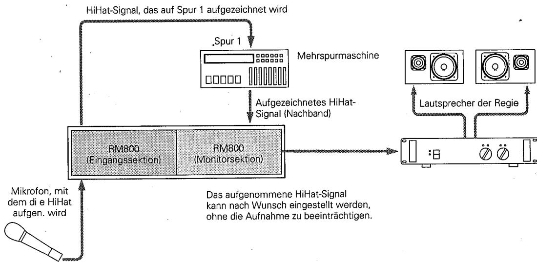
Auf einem In-Line Pult kann man die Mehrspurwiedergabe nach Wunsch einstellen, indem man die Monitorsektion eines Kanalzuges verwendet, während der Fader, der EQ usw. ausschließlich dazu dienen, den Pegel des aufzunehmenden Signals zu optimalisieren.
