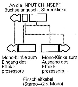
Hierfür bieten sich in ersten Linie die den Gruppen 7 und 8 zugeordneten Signale an, weil das RM800 mit GROUP INSERT I/O 7/8 Buchsen ausgestattet ist. Planen Sie Ihre Quelle/Spur-Zuordnung also immer so, daß die gewünschten Signale mit externen Signalprozessoren bearbeitet werden können.
