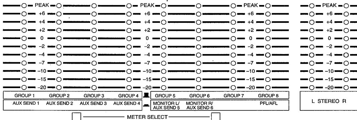
El RM800 se caracteriza por diez medidores LED de 11 segmentos, y permite la medición del nivel de salida para todas las salidas. Los medidores STEREO están dedicados a la salida estéreo, mientras que los medidores GROUP son medidores de doble función. Los selectores METER SELECT se utilizan para elegir qué señales se visualizarán. En la tabla siguiente se muestra la forma en la que trabajan.
