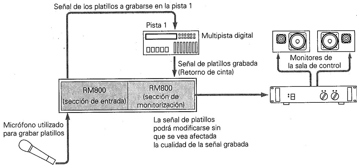
En la consola en línea, la *reproducción* multipista podrá mezclarse en la forma requerida utilizando la "sección de monitorización" de un módulo de canales, mientras que las posiciones del regulador de nivel de entrada, del ecualizador, etc., se ajustan para optimizar el nivel de la señal en cada pista de la grabadora.
