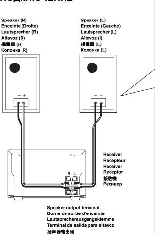
Выходной терминал колонок
