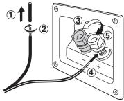
When using a banana plug Lorsqu'une fiche banane est utilisée Bei Verwendung von Bananensteckern Cuando utilice una clavija tipo banana
