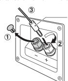
Banana plug **Fische Banane** Bananenstecker Clavija tipo banana 香蕉形插頭 Вилка штекерного типа
