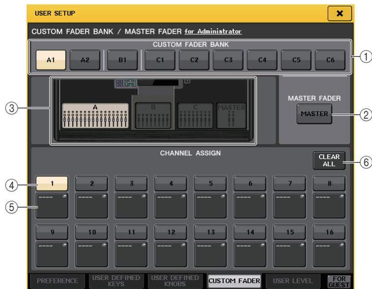
**3.** Press the **CUSTOM FADER** tab to access the **CUSTOM FADER BANK/MASTER FADER** page.
