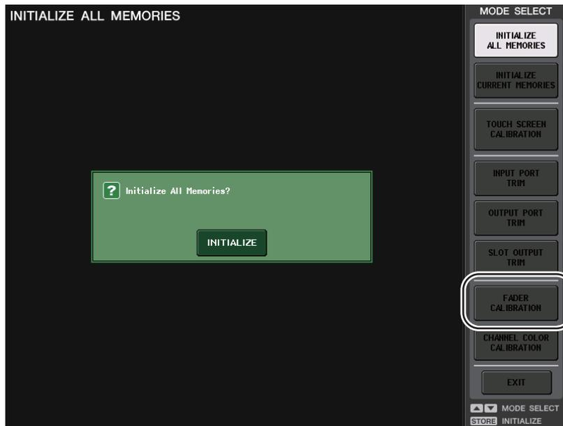
2. Press the FADER CALIBRATION button.
