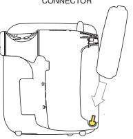
2. ROTATE RECEIVER AND CONNECTOR INTO BOOMBOX
