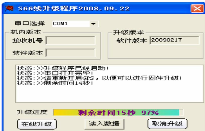
打开主机后自动写入程序，升级进度处可以看到进行程度
