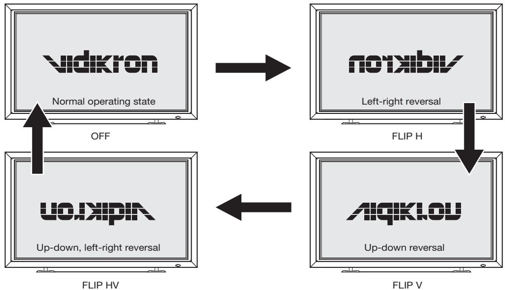
**Figure 4-8. Picture Orientation**
