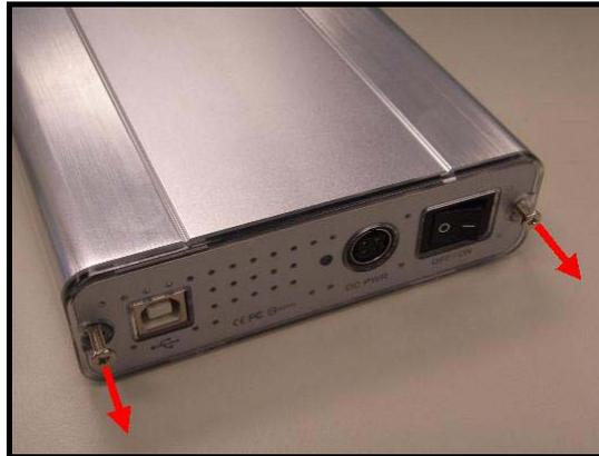
图 2. 将两颗螺丝从侧边盖板移除
