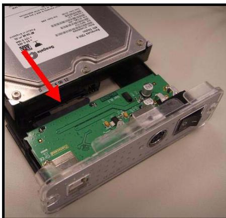
图 5. 连接 SATA 控制板至 SATA 硬盘
