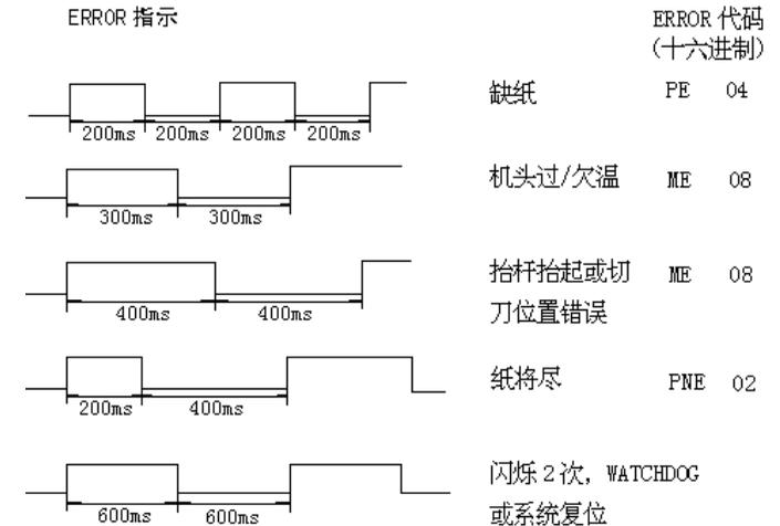
当打印部件出现上述故障时，会自动通过接口 TXD 送出一字节 ERROR 代码，打印机状态亦可通过响应 ESC v 命令送出。
