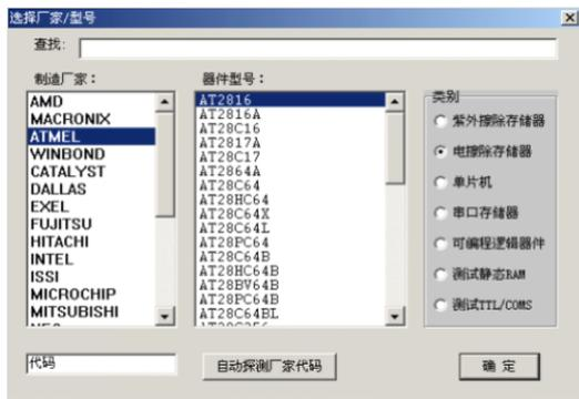
芯片型号的选择过程按照：类型—>生产厂家—>型号的顺序确定芯片型号。
