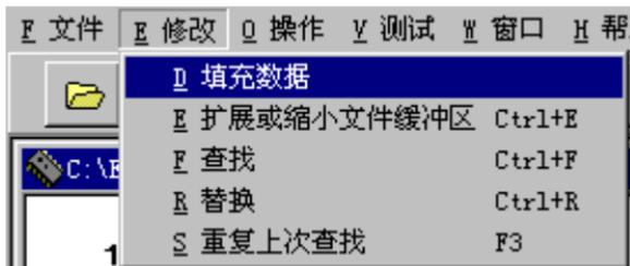
2.2.1 填充数据：对应的工具图标按钮为“**填充**”。本操作可把缓冲区部分单元填充为所需的数据。
