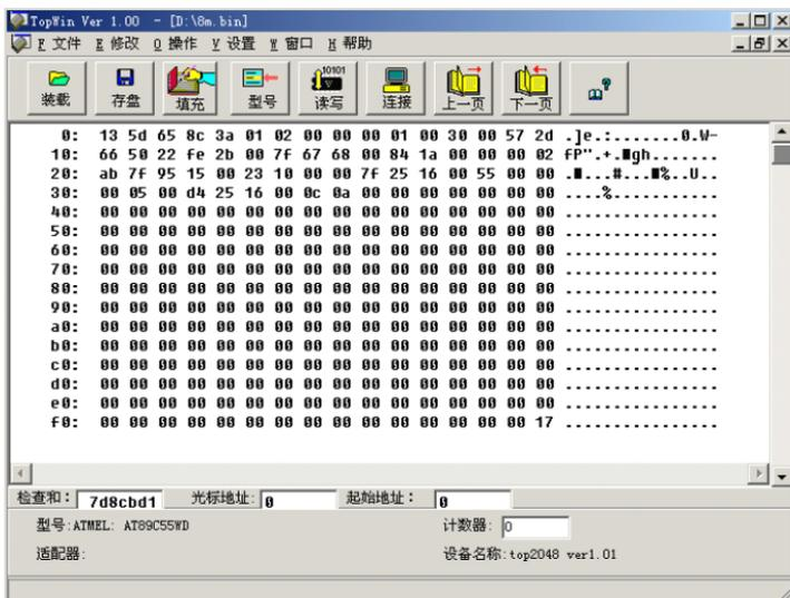
软件界面由菜单栏、工具栏、缓冲区、状态栏、报告栏组成，其中5个菜单中包括了TOPWin操作的全部功能和选项，工具栏上设置了常用的工具图标按钮，其效果与菜单中经常要用的操作完全相同，采用单击的方法使得命令的调用更加方便而快速。
