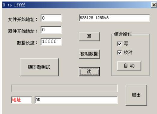
本菜单主要用于测试常用的静态存储器 SRAM, 按“自动”按钮，编程器对存储器的每一位进行测试，确保测试的可靠性。
