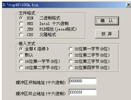
确认打开文件的文件格式、缓冲区的起始和终止地址后，文件数据装入到缓冲区，显示如下：
