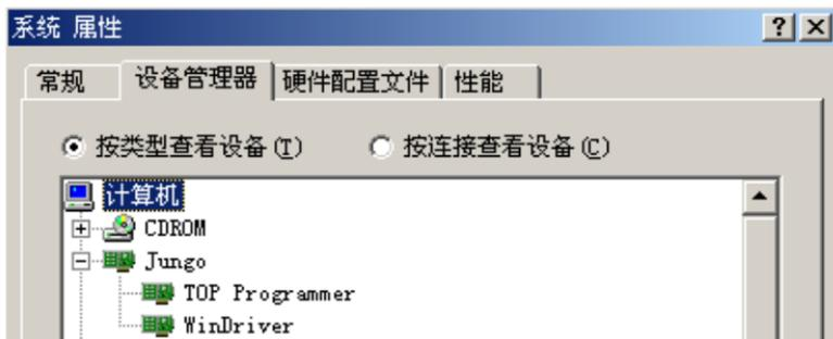
没有连接编程器时(Jungo/WinDriver):
