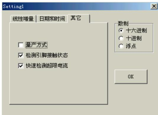
● **量产方式:** 如果允许, 在写器件时, 只要按一次“自动”, 以后自动检测器件是否插牢, 一旦器件正确安放好了, 立即开始写过程。运行完一次, 会显示“OK, 请取走写好的器件”, 拿走器件以后, 又会显示“放置下一片...”, 下一片放好以后, 程序检测到所有引脚接触良好后, 自动循环操作。省去反复按鼠标, 适合大批量烧录。
