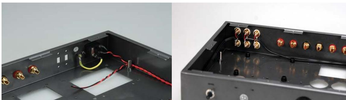
(2) 安装RCA信号输入端子(注意端子接地片不要与机壳相连,用自带的塑料垫片隔离,并为以后2个接地片统一连接,做好折弯)。如图所示:
