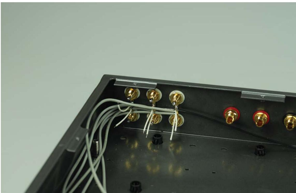
7、重点检查整机所有接地螺丝是否与机壳完全接触，各接地引线是否正确接地。
