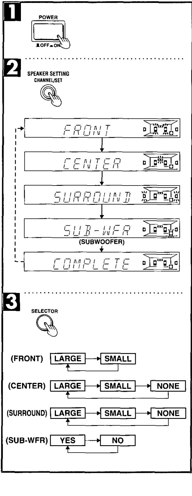
Sélectionner le type et établir la présence (YES, NO ou NONE) des enceintes avant d'y acheminer un signal.
