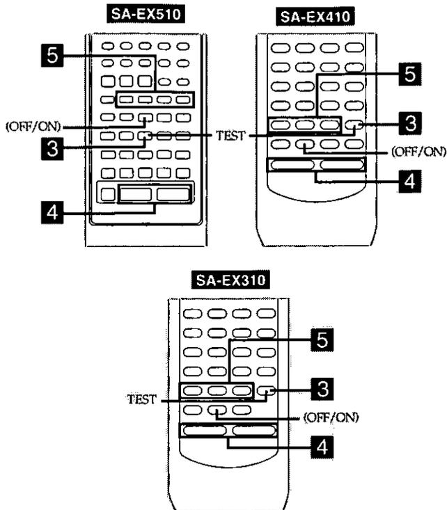
**3 Press TEST to output a test signal.**
