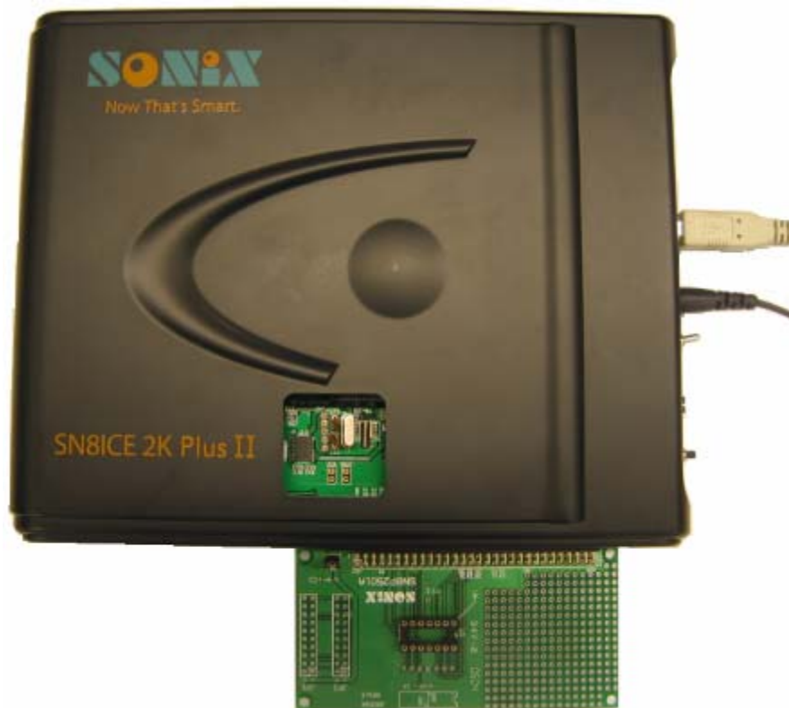
图 2.4 仿真板连接示意图
