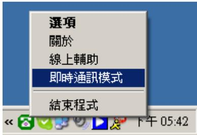
有些即時通訊軟體的應用介面中可選擇音訊裝置，如 Skype 和 Yahoo!奇摩即時通訊。使用者需先確認 SkyATA-101 裝置已接妥至電腦 USB 埠，在即時通訊中設定 SkyATA-101 作為音訊裝置後，使用者將可透過 SkyATA-101 所接的電話與從電腦上撥打或接聽的聯絡人通話。若所使用的即時通訊軟體中沒有應用介面去設定音訊裝置時，使用者可將電腦系統音訊裝置設定為 SkyATA-101。但此時電腦所撥放的音樂也將會由外接的話筒輸出。電腦系統音訊裝置設定也可藉由 SkyATA-101 系統工作列之選項頁中，調整音訊輸出及輸入裝置為 SkyATA-101 後，再點擊“確定”或“套用”即可，如下圖：
