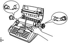
5. Tire de la bobina vacía hacia el fondo del compartimiento, desenrollando la parte anterior de la bobina de película. Inserte la bobina vacía en el compartimiento de forma que la ruedecilla y la bobina encajen en las ranuras que hay a ambos lados del compartimiento.
