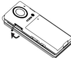
2. 将存储卡插入到位。（若要取出存储卡，请轻推存储卡，直到其发出咔嗒声。）
