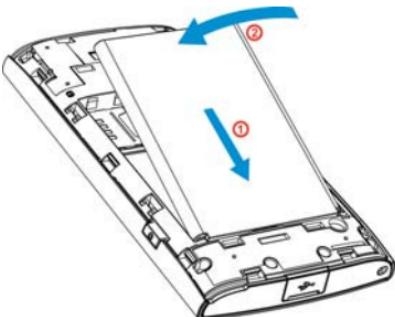
8. 如图所示插入电池后盖,然后向下扣上电池后盖。
