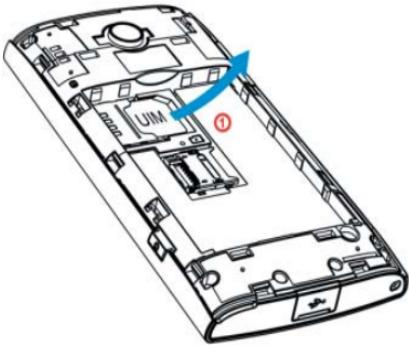
5. 插入SD卡,如图中①所示的方向滑动SD卡架如图②所示方向打开卡架,如图③所示插入SD卡,如图④方向合上卡架,如图⑤方向推动卡架。
