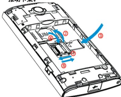
6. 取出SD卡,如图中①所示的方向推动SD卡架如图②方向打开SD卡卡架,按照③方向拔出SD卡。
