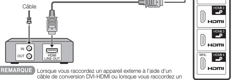
**REMARQUE** Lorsque vous raccordez un appareil externe à l'aide d'un câble de conversion DVI-HDMI ou lorsque vous raccordez un appareil compatible ARC, utilisez HDMI 1.
