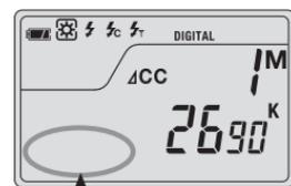
Lorsque la mesure de la température de couleur ou de l'éclairage lumineux simplifié est affichée sur l'écran LCD, le nom et numéro de préréglage ne sont pas affichés.
