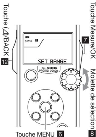
**H**: Sélectionnez ceci quand la puissance de sortie du flash est élevée. Lors de la mesure, si la puissance du flash est trop faible, [**U**, *Under*] clignotera sur l'écran. Dans ce cas, basculer la portée de H à L.
