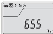
Mesure de l'éclairage lumineux (affiché en lux)
