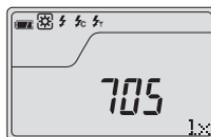
Misurazione dell'illuminamento (Visual. in lux)
