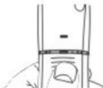
用拇指下压舱盖上部痛点处，同时往下（手机底部）推动，将电池舱盖取下。
