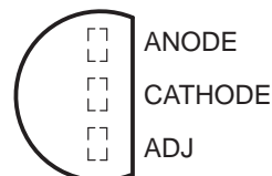
LM336-2.5, LM336B-2.5 . . . LP PACKAGE (TOP VIEW)
